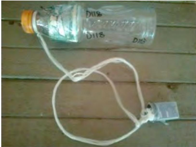
**FIGURA 5.** Imagen sobre la forma como se debe preparar el sensor de temperatura previo a los patrullajes nocturnos.
