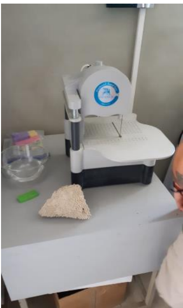
Figura 3. Demostración del uso de la cierra de diamante en el corto de fragmentos de coral del tipo masivo.
